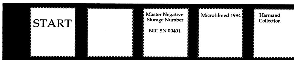
Figura 34. Sinalética de densidade uniforme com uma imagem por fotograma em modo horizontal (IB)
