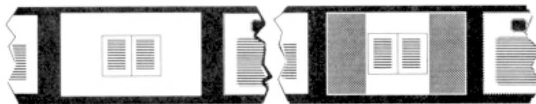
Figura 13. Item pequeno sobre superfície branca microfilmado com a máscara aberta (esquerda) e com a máscara ajustada para minimizar o espaço 'vazio' visível (direita)
