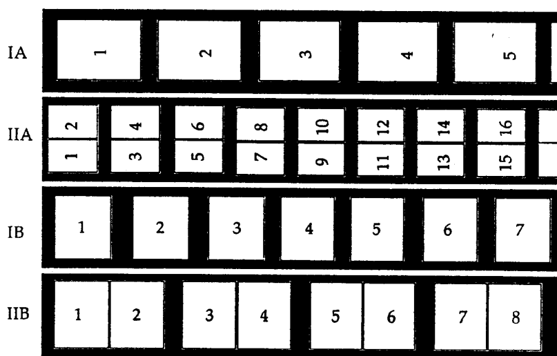
Figura 5. Posições de microfilmagem: horizontal (acima) e vertical (abaixo)
